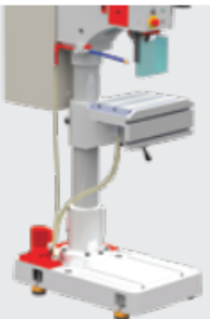
Soğutma Suyu Motoru
